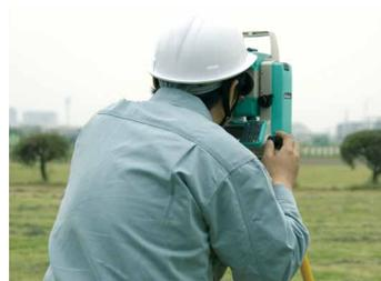
精密測距モードは $\pm(3+2\text{ppm}\cdot D)\text{mm}$ の高精度で初回・連続ともに約1.6秒。高速測距モードは $\pm(10+3\text{ppm}\cdot D)\text{mm}$ で連続1.0秒(初回約1.4秒)の高速測距を実現しています。
