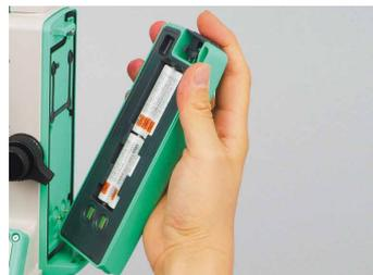
単三電池型Ni-MH4本をフル充電すれば、1日の作業を十分にカバーできます。万一のバッテリー不足時も、単三電池で対応できるため便利です。
