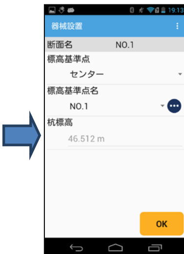
④-1 器械設置
