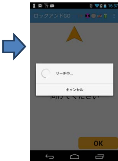
④回転後、サーチが開始されプリズムをロックします。
