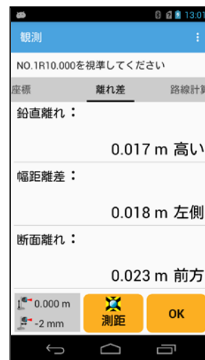
⑤観測点と設計データとの差分を表示します。(出来形と同等の機能を有します)
