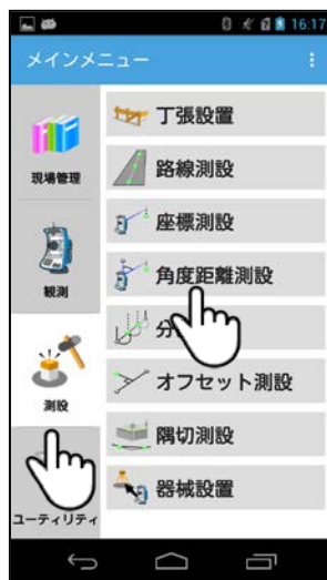
①メインメニュー「測設」/「角度距離測設」をタップします。
