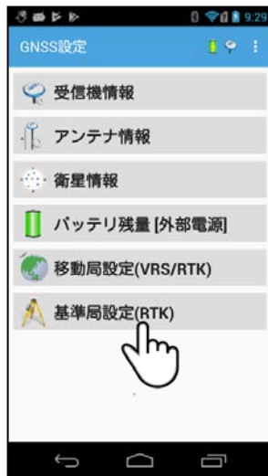
②基準局設定(RTK)をタップします。
