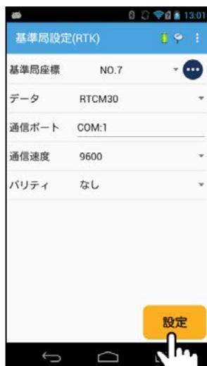
⑤通信パラメータを設定し、設定をタップします。
