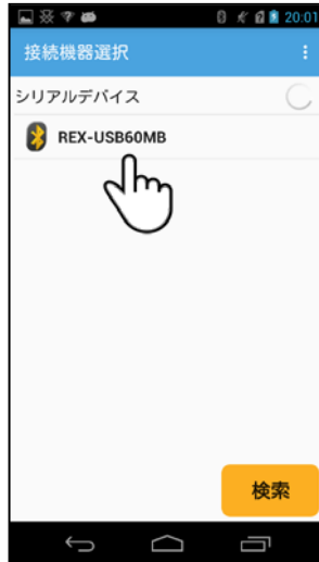
②Panasonic FZ-X1 に専用ケーブルを差し込み、 REX-USB60MB をタップします。
