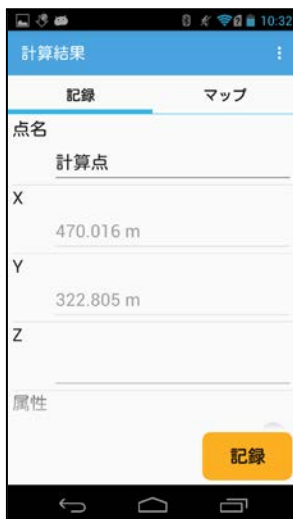
④計算結果画面を表示します。「 記録 」ボタンで計算座標を登録します。記録後、計算点選択画面へ戻ります。
