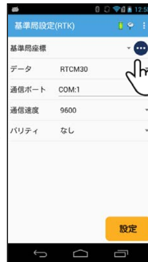
③基準局座標の右端のアイコンをタップします。
