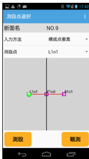
④-2 断面上の構成点要素を選択します。
