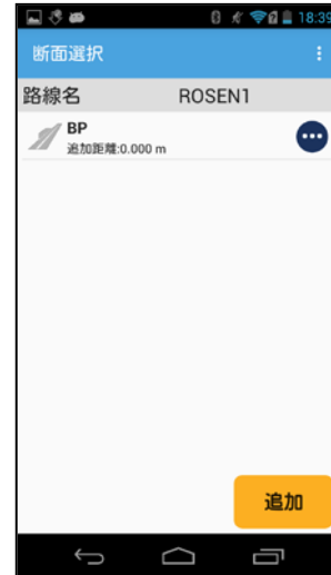
③観測対象断面の新規作成のみ「追加」ボタンをタップします。既存の断面を利用し観測する場合は、リスト上の断面をタップしてください。
