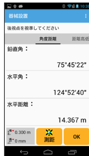
④-3 器械設置
