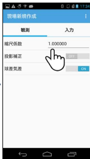
④縮尺係数はこの画面でのみ変更可能です。縮尺係数を利用しない場合は1.0を入力して下さい。
