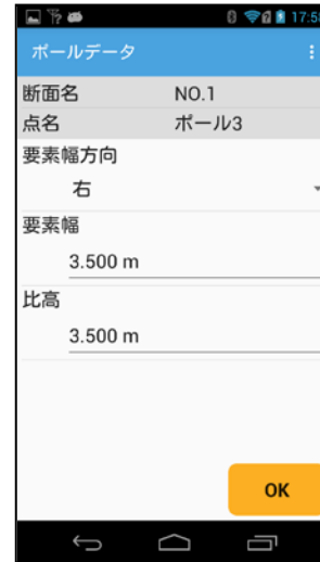
⑥ポールデータの編集を行います。要素幅方向は路線進行方向に対する左右値です。
