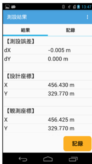
④測設結果を表示します。「OK」ボタンで測設結果を作業ログに記録し、測設点選択画面へ戻ります。
