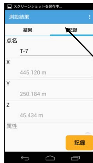
⑤測設点座標記録画面を表示します。「記録」ボタンで観測座標を登録します。記録後、測設点選択画面へ戻ります。
