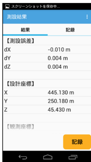
④測設結果を表示します。「OK」ボタンで測設結果を作業ログに記録し、測設点選択画面へ戻ります。
