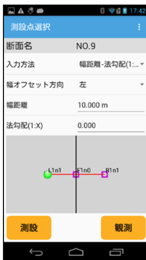
④-1 路線要素のパラメータ(幅距離／比高など)を入力します。
