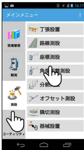
①メインメニュー「測設」/「路線測設」をタップします。
